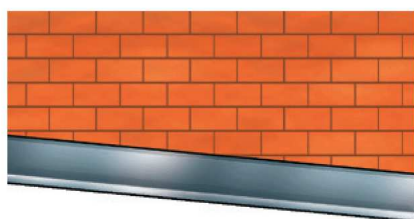
Tuiles plates tranchées en égout
