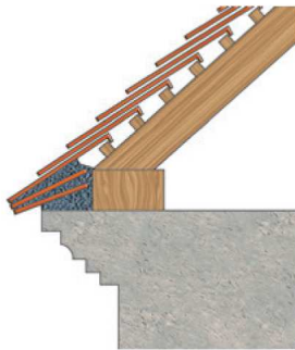
Figure 5 Égout scellé en tuiles plates (de terre cuite ou en béton)
